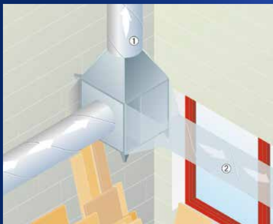
① und ② Variable Einbaurichtungen
