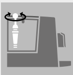
Filter in Wassertank eindreihen
