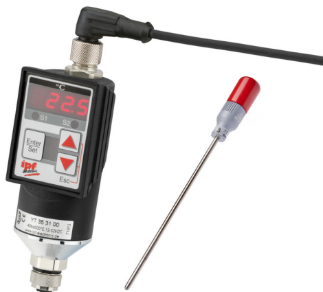
Abbildung 5: Die PT100 Fühler YT036020 eignen sich für den Einsatz im Temperaturbereich von -30°C bis maximal +350°C und sind in der Anwendung bei Bandstahl Schulte über eine Sensor-Aktor-Leitung mit den Temperaturanzeigen (maximale Umgebungstemperatur +80°C) gekoppelt.
