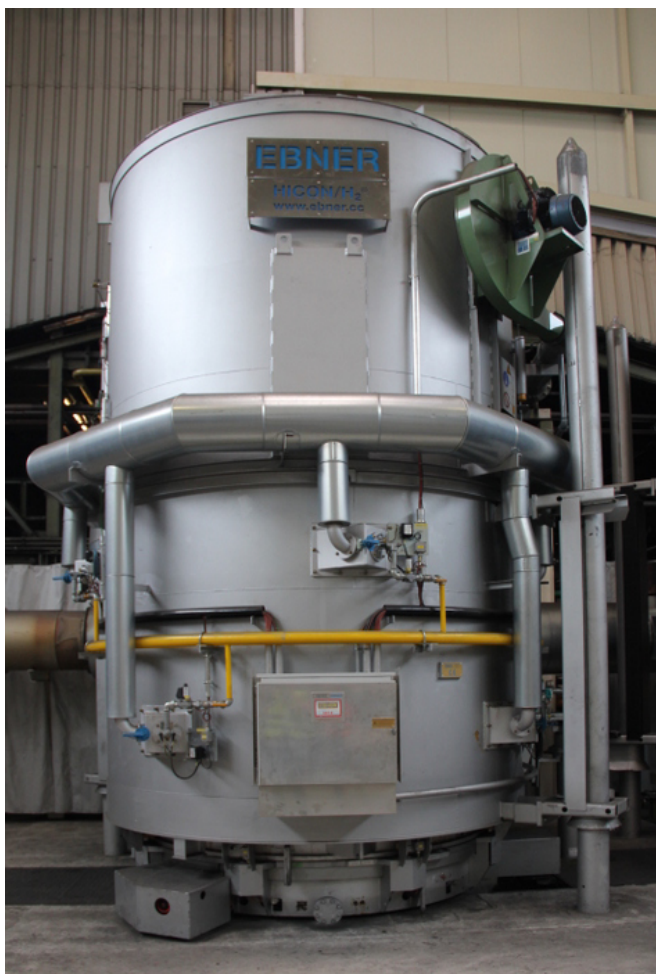
Abbildung 8: Erste Erkenntnisse zeigen, dass den Abgasen der Wasserstoff-Haubenglühe mit wenig Energie sehr viel Wärme entnommen werden kann.
